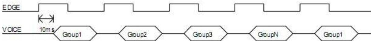
此触发方式仅限于在 OKY1, OKY2 端口。收到正脉冲信号后开始播放第一段地址语音，再次收到正脉冲信号则播放第二段地址语音，依次发到最后一段后，再次触发则重新开始播放第一段语音，如此循环。
