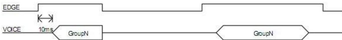
收到正脉冲信号后开始播放语音，正脉冲信号停止时，语音也停止播放。如果正脉冲信号一直保持，并且持续的时间超出语音播放的长度，则播放完语音即停止，不再继续播放语音。
