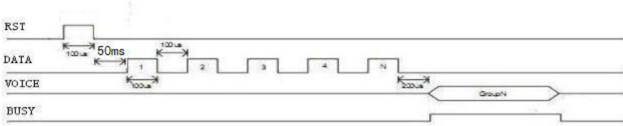
注:  $50\mu s < \text{脉冲高电平时间} < 200\mu s$ ;  $N < 62$ , RST 复位后等待大于 50MS 再发数据
