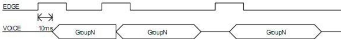
收到正脉冲信号后开始播放语音，在语音结束前如果还收到第二次正脉冲信号，则重新开始播放语音，在语音播放的过程中无收到正脉冲信号则播放完整段语音。
